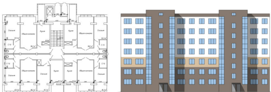
Рисунок.3 Вариант объемно-планировочного решения серии 1-335 (типовой)
